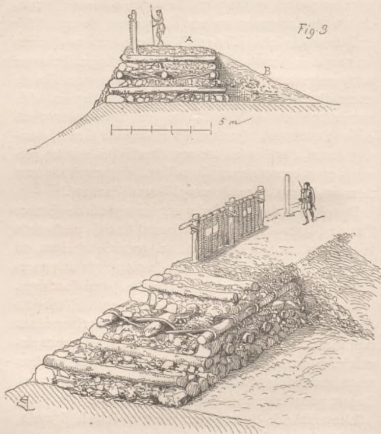
les glacis B permettant de monter facilement sur ce chemin de ronde.
