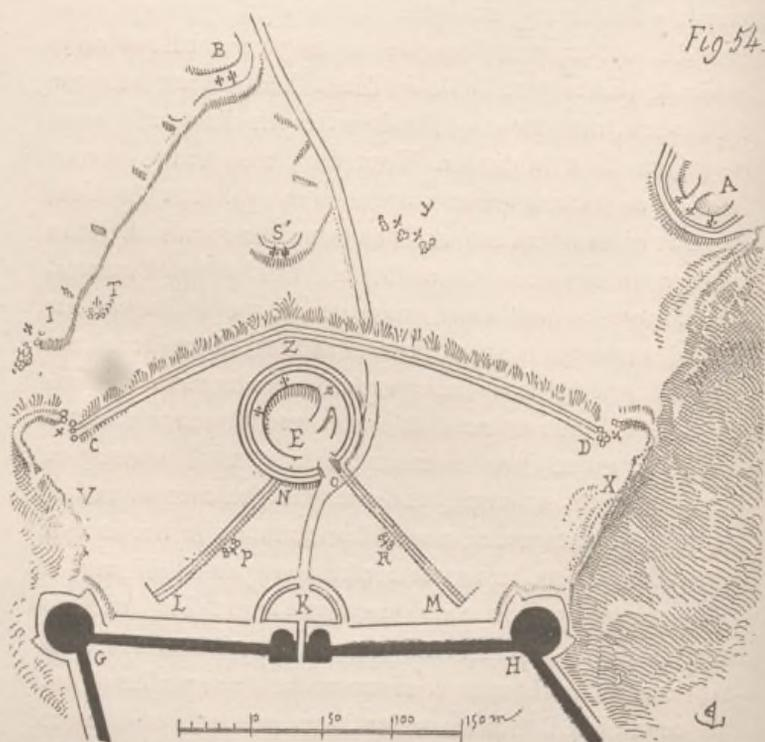
Du côté de l'Ouest, il s'appuyait au boulevard en N et venait joindre le fossé de la courtine en L, laissant un passage de quatre toises entre son extrémité et ce fossé. Du côté de l'Est, il touchait en O à l'entrée du boulevard et suivait la ligne O M avec passage de même en M. En R
