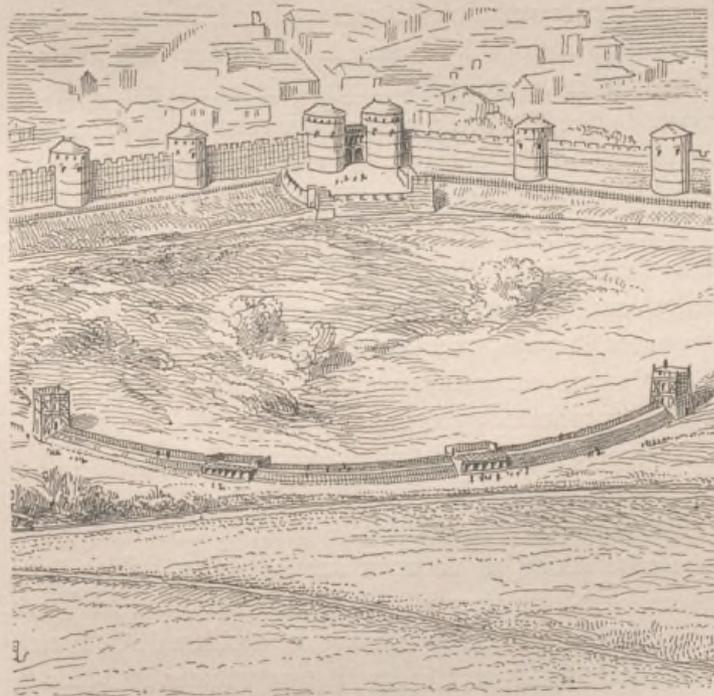
borner à établir au bas du rampant du plateau un ouvrage en terre et bois formant une portion de cercle, conformément au tracé ci-contre (fig. 22).
