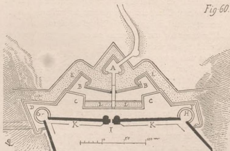
Errard fit élever deux fronts K et L à crémaillères, pour commander les rampes du plateau à droite et à gauche et empêcher l'assaillant de se loger sur les flancs Est et Ouest de la cité.
