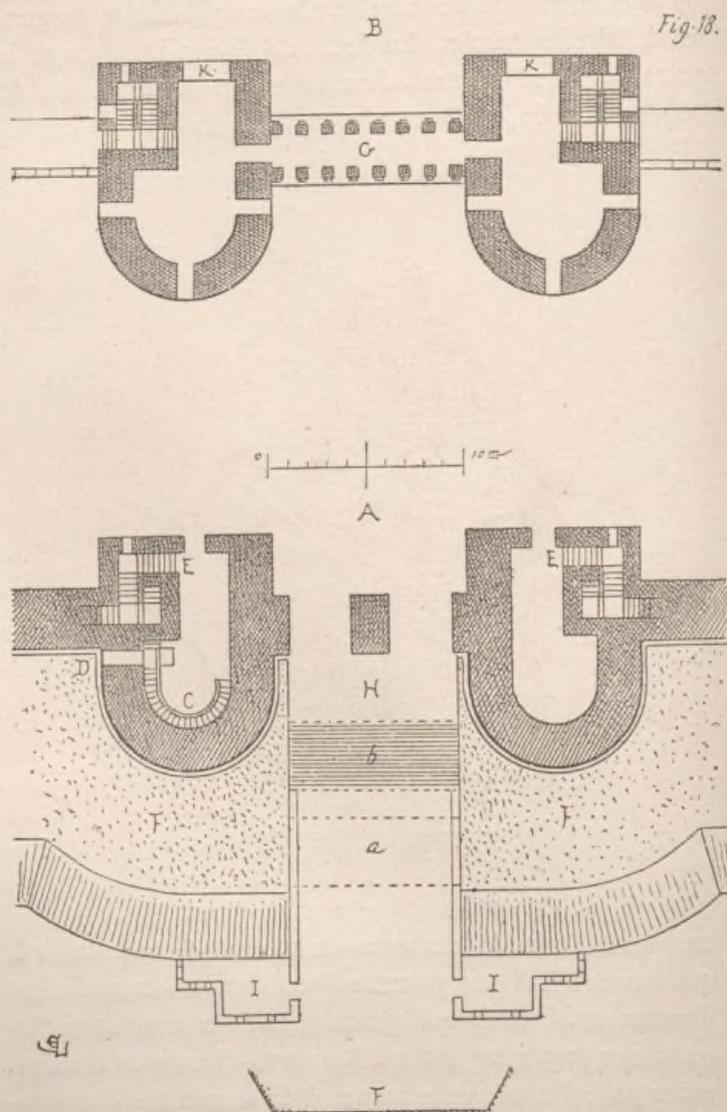
un tablier *b* de bois qui pouvait être rapidement enlevé en temps de siège. Alors sur la plate-forme *H*, on devait élever un tambour de charpente qui masquait entièrement les deux arcades. En dehors du pont, muni d'un crénelage sur la partie maçonnée, deux petits postes découverts *I*, défendaient les approches et une palissade *F* obligeait les arrivants de faire un circuit pour passer sur le pont. La fi-
