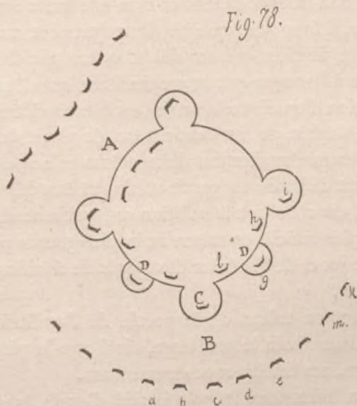
front d'attaque comme quantité d'armes de jet et très-supérieur par le relief et la protection. Mais naturellement alors l'attaque dispose ses engins ainsi qu'on le voit en B. De telle sorte que les projectiles envoyés de *a b c d e* convergent sur le saillant C. La défense ajoute les nouveaux appendices D D, et si ses engins sont bien protégés, elle peut faire converger les projectiles *g, h, i* sur l'engin K et
