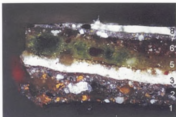
2 Muestra 410-5. Fondo sobre rostro subyacente. Falta la preparación. 1 Negro carbón (dibujo subyacente). 2 Mezcla de albayalde, negro carbón, calcita y minio (fondo de la carnación). 3 Rosado (carnación subyacente): albayalde, calcita, laca roja. 4 Barniz oleoso. 5 Verde del paisaje: cardenillo, índigo, litargirio. 6 Barniz oleoso. 7 Gris verdoso (repinte antiguo): calcita, albayalde, índigo, negro carbón.
