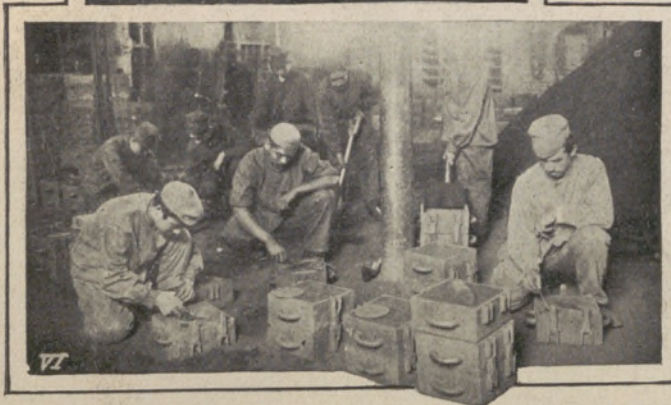
I. Señor don Rafael Puelma, director de la Escuela de Artes y Oficios.—II. Taller de herrería: caldeando el hierro.—III. Don Baudillo Herrera, sub-director.—IV. Dando macho.—V. Mecánica: limaduras de hierros.—VI Fundición: amoldando en cajas.
