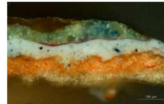
5. Imagen obtenida con microscopio óptico de la sección transversal de una muestra de *El papa Alejandro III consagra a Antelmo de Chignin como obispo de Belley* de Vicente Carducho (P-5408). Se aprecia una doble capa de imprimación: pardo amarillenta la inferior y rojiza la superior.
