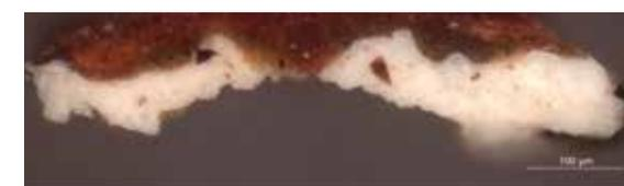
3. Detalle de *Las lanzas* (P-1172) e imagen tomada con microscopio óptico de la sección transversal de una muestra en la que se observa la imprimación de tono gris claro de albayalde.
