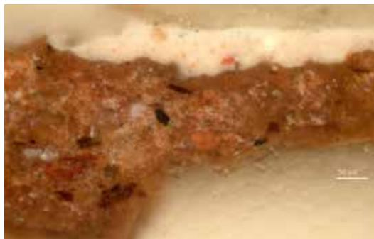
6. Imagen obtenida con microscopio óptico de la sección transversal de una muestra de *El Fuego* de Antonio Palomino (P-3186). Se aprecia la heterogeneidad de la imprimación pardo rojiza que contiene almagra con abundantes partículas incoloras.
