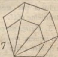
Il ne restera plus qu'à mener des parallèles aux divers côtés, telles que le montre la fig. 7, et qui soient limitées aux diagonales; on aura ainsi formé un polygone semblable au premier.
