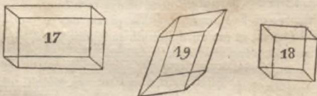
16, 17 et 18. *Faites un parallélipède droit*, fig. 17, *oblique*, fig. 19. Quand la base du prisme est un parallélograme , le corps prend le nom de *parallélipède* ; toutes les six faces sont alors des parallélogrammes dont les opposés deux à deux sont égaux.
