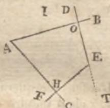
2. *Faites deux triangles à côtés perpendiculaires*, fig. 2. Après avoir fait un premier triangle, on en formera un second, en faisant d'abord un angle à côtés perpendiculaires, comme on vient de le dire, et fermant celui-ci par une perpendiculaire au troisième côté.
