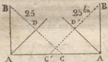
48. Coupez un angle droit par la moitié, fig. 25. Pour qu'un angle BAC soit coupé en deux parties égales par une droite AD, il faut que cette ligne AD soit autant inclinée sur un côté AC, que sur l'autre AB : si l'on conçoit la figure pliée selon AD, les parties des deux côtés coïncideront, AB se couchera sur AC.
