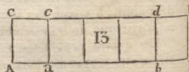
32. *Faites un rectangle*, fig. 12. On nomme ainsi une fig.  $A B C D$ , qui a quatre côtés dont les opposés sont égaux et parallèles deux à deux, et ses quatre angles droits : c'est ce que les ouvriers appellent un *carré long*.  $A B$  se nomme la *base*;  $A C$  la *hauteur*. On aura soin d'assigner en décimètres et centimètres les longueurs de ces deux lignes; ainsi on dira, par exemple, *faites un rectangle de 12 centimètres de base et de 21 de hauteur*.
