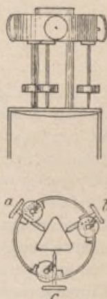
Fig. 6. — Support métallique maintenant un échantillon en expérience.
