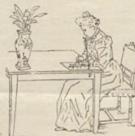
Pour le dessin à l'intérieur, l'appareil peut être placé en fixant le pied à étau au bord d'une table ordinaire sans moulure ou à défaut sur le bord d'une planche à dessin ou d'une rallonge de table.
