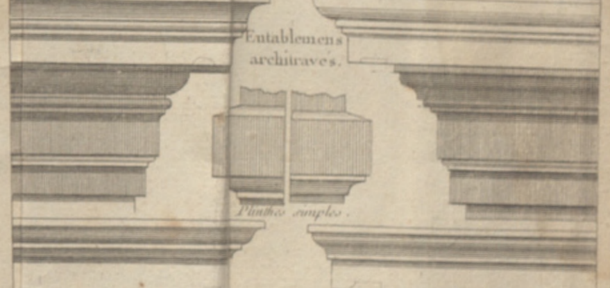
Etablemens simples pour porter les Cheminées et les Combles.
