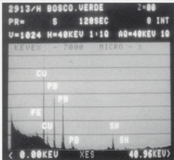
Fig. 12. Análisis del verde. Fluorescencia de R.X. (2913/H).
