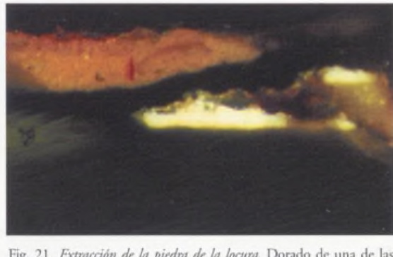
Fig. 21. Extracción de la piedra de la locura . Dorado de una de las letras de la inscripción. Estratigrafía de la muestra 2056-5. Se observa la imprimación general de color blanco de albayalde, sobre el que se aplica el fondo negro sobre el que se pintaron las letras de la inscripción. La técnica del dorado es de asiento con albayalde, ocre y negro al óleo y pan de oro con adhesivo mordiente.
