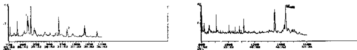
Fig. 44. Análisis por cromatografía gaseosa con detección mediante espectroscopia de masas de una muestra de barniz tras metilación.
