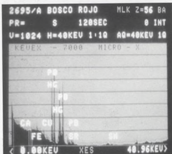
Fig. 7. Análisis del rojo del ballestero. Fluorescencia de R.X. (2695/A).
