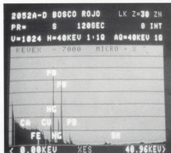
Fig. 62. El Carro de Heno . Tocado rojo del sacamuelas. Fluorescencia de R.X. (2052/A-D).
