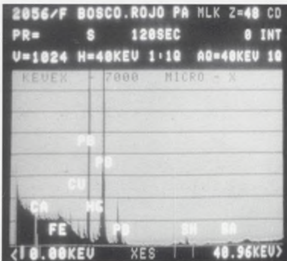
Fig. 13. Análisis del rojo del pantalón del enfermo. Fluorescencia de R.X. (2056/F).
