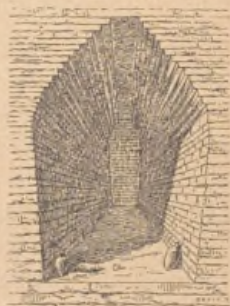
Fig. 4. Voûte en encorbellement de Mughéir (d'après Taylor).
