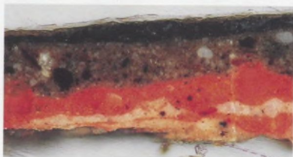
Fig. 7.- Micromuestra. Localización: Azul del manto de la Virgen, sobre la costura del soporte . Encima de la estructura de la preparación en la costura, en la que se sobreponen capas de albayalde y minio de plomo, aparece el grueso estrato de pintura relativo al primer manto de la Virgen, de tonalidad gris-violácea, oculto bajo la fina capa azul de la remodelación en la que se mezclan el esmalte, el añil y la azurita
