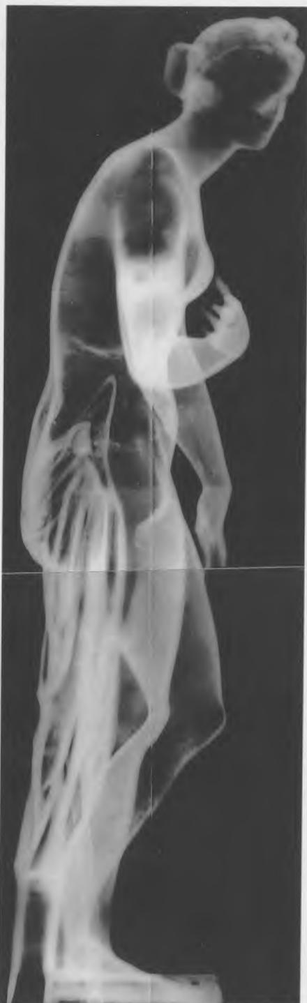
*Gammagrafía lateral. Condiciones de trabajo: fuente de cobalto 60, a 15 curies, 10 horas, 5 m. de distancia. Película tipo 2.*
