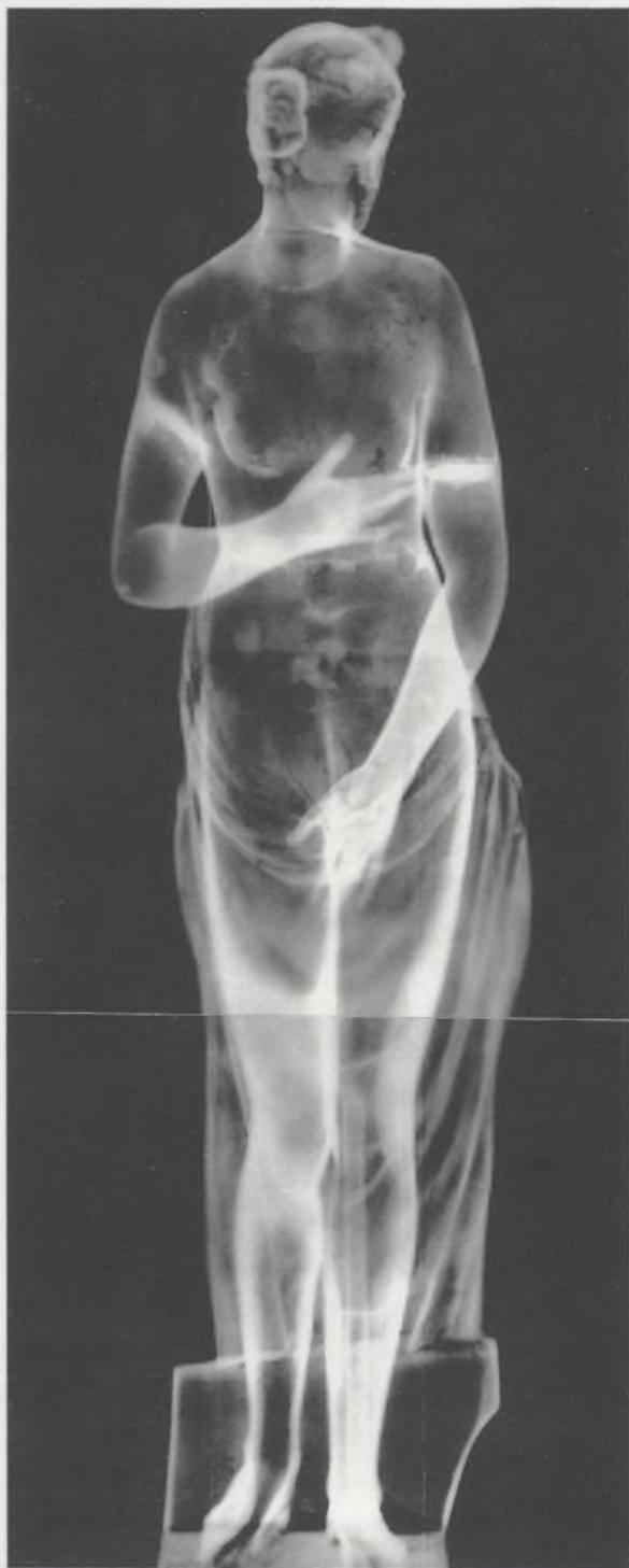
*Gammagrafía antero posterior. Condiciones de trabajo: fuente de cobalto 60, a 15 curies, 10 horas, 5 m. de distancia. Película tipo 2.*
